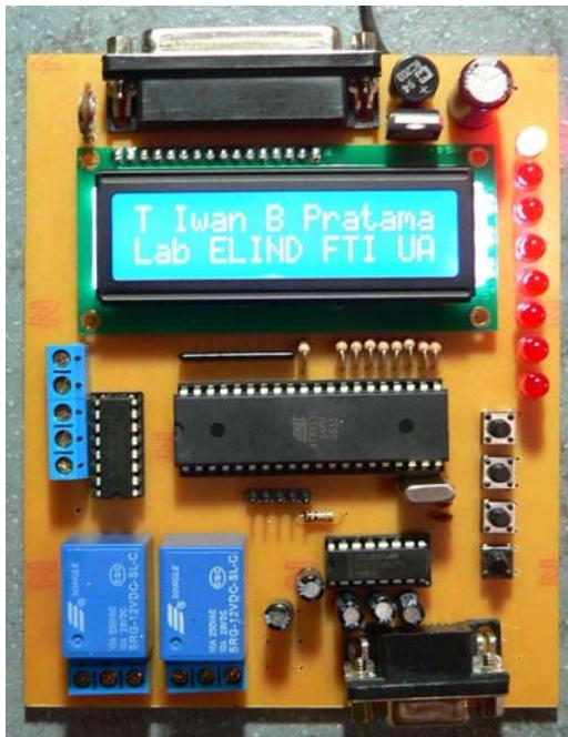
Papan percobaan AT89S51 terdiri dari mikrokontroler AT89S51, 8 led merah, LCD 16x2 karakter, driver IC ULN2003 untuk menggerakkan motor DC atau motor stepper, 2 relay untuk menggerakkan peralatan DC maupun AC, 4 push button untuk memberikan input data atau interupsi ke mikrokontroler, interface RS232 untuk komunikasi serial dengan komputer dan konektor DB25 untuk komunikasi paralel dengan komputer atau printer.
