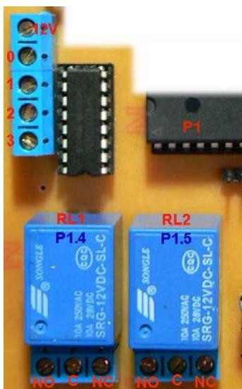
IC penggerak ULN2003 digunakan untuk menggerakkan peralatan DC seperti kipas DC 12V. Tersedia 4 terminal 0, 1, 2, 3 yang dihubungkan ke Port P1.0, P1.1, P1.2 dan P1.3 lewat IC ULN2003. Output ini aktif logika tinggi.
