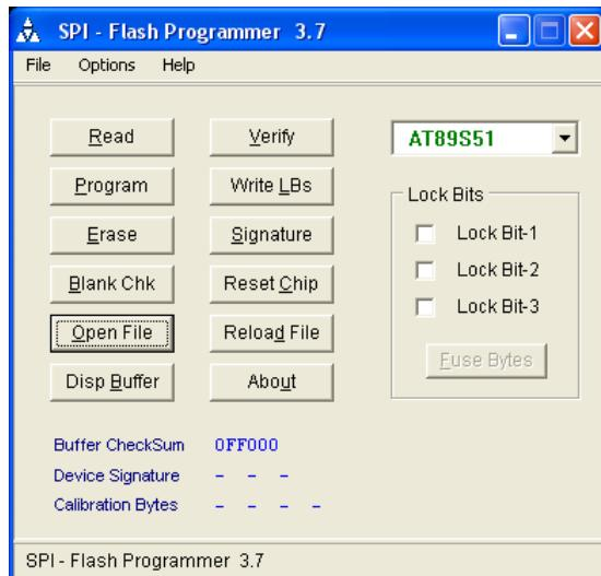
Tampilan programmer seperti gambar di samping. Buka file MOD501.HEX dengan klik “Open File” Pilih tipe mikrokontroler yang sesuai (AT89S51) Klik “Signature” untuk mengetes mikrokontroler yang terhubung.
